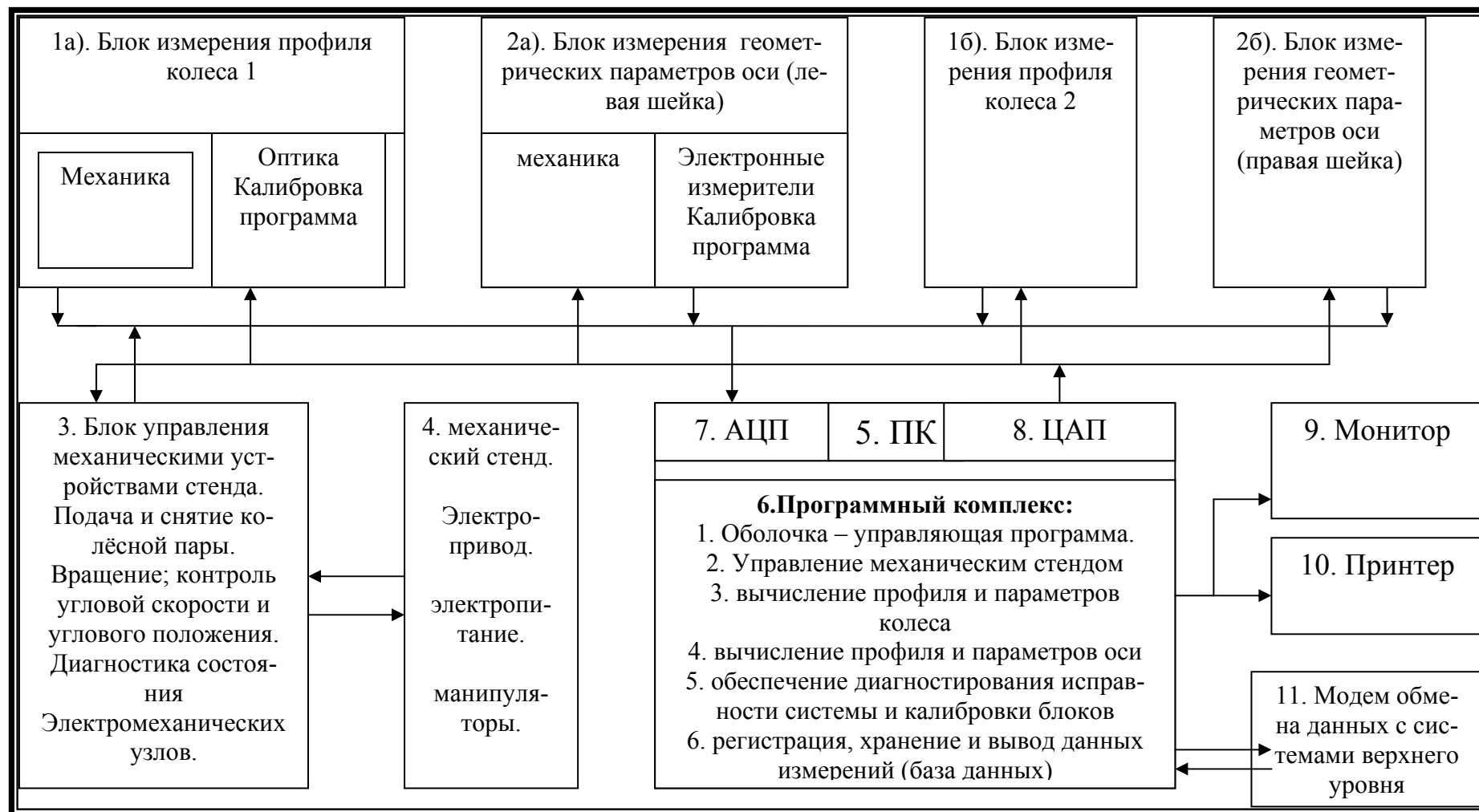
Рис. 1.1. Блок – схема АСК ГПКП Геопар.
