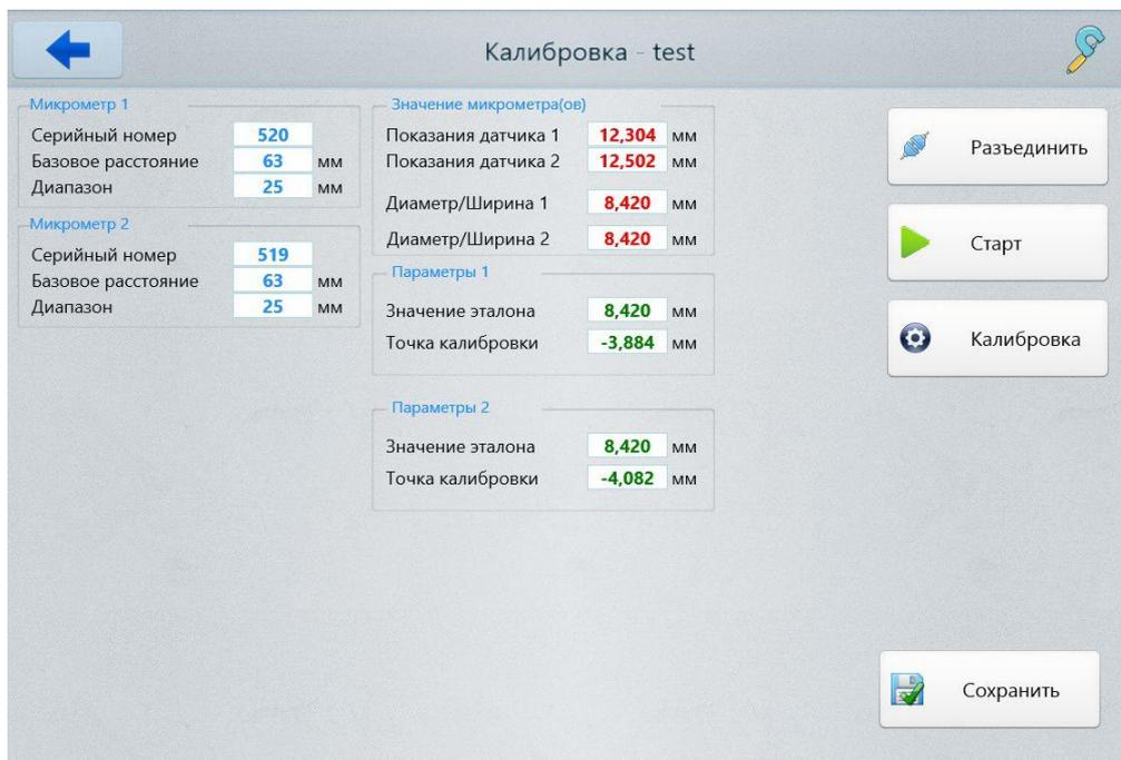
Если значение параметра **Диаметр/Ширина** равно значению параметра **Значение эталона**, калибровка выполнена правильно. Нажать кнопку **Сохранить**.
