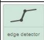
"edge detector" - поиск перепада высоты между двумя отрезками на профиле.
