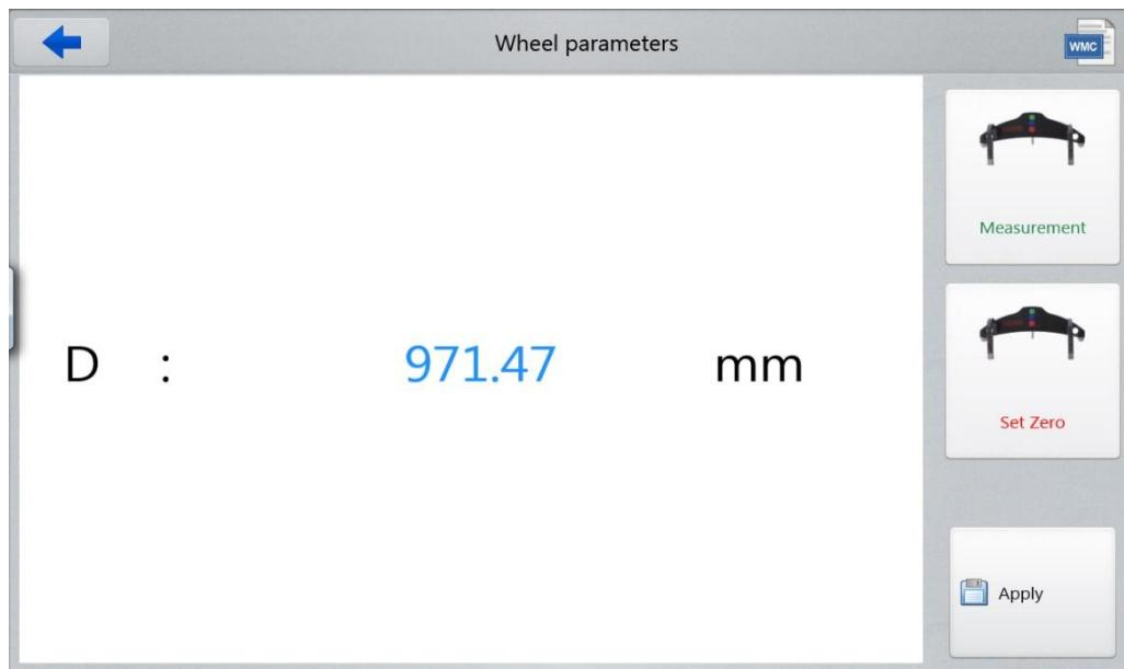
Каждый результат измерений ИКР,>IDК, IMR по одному колесу после сохранения будет храниться в одном отдельном файле WMC.
