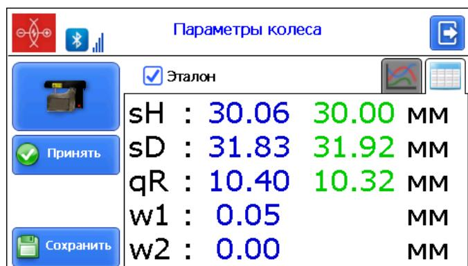
После каждого проведенного измерения, для того, чтобы сохранить текущие показатели прокатов нужно нажать кнопку **Принять**. При последующих измерениях программа будет автоматически находить максимальный и минимальный износ колеса, и рассчитывать равномерный и неравномерный прокат.
