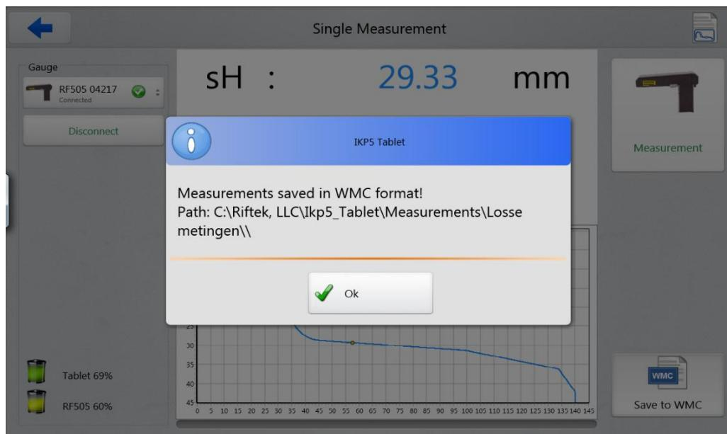
Для измерения диаметра колеса или межбандажного расстояния используется IDK или IMR. Для этого необходимо нажать кнопку **Disconnect** и выбрать нужное устройство измерения. После выбора, нажать кнопку **Connect**.
