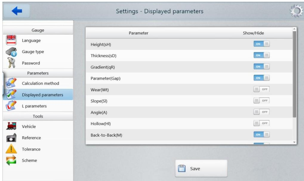
Для выбора/отмены параметра установите **ON/OFF** в колонке **Show/Hide** напротив нужного параметра. Чтобы сохранить изменения, нажмите **Save**.
