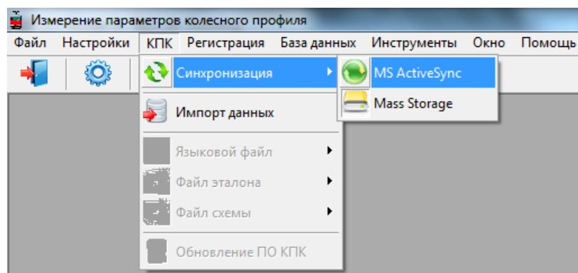
При выборе пункта **Mass Storage** при подключении КПК к ПК устройство определится в системе Windows как внешнее запоминающее устройство.
