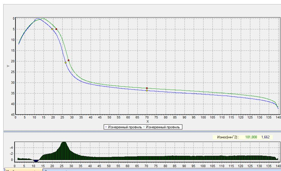
На графике выводятся положительное и отрицательное значения площади износа. Площадь рассчитывается в миллиметрах квадратных относительно выбранного эталонного профиля
