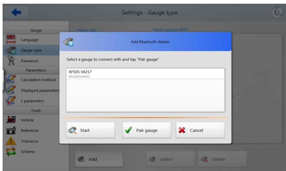
Затем выберите устройство и нажмите **Pair gauge** для включения его в список. Windows сообщит о попытке добавления нового устройства и запросит код сопряжения.
