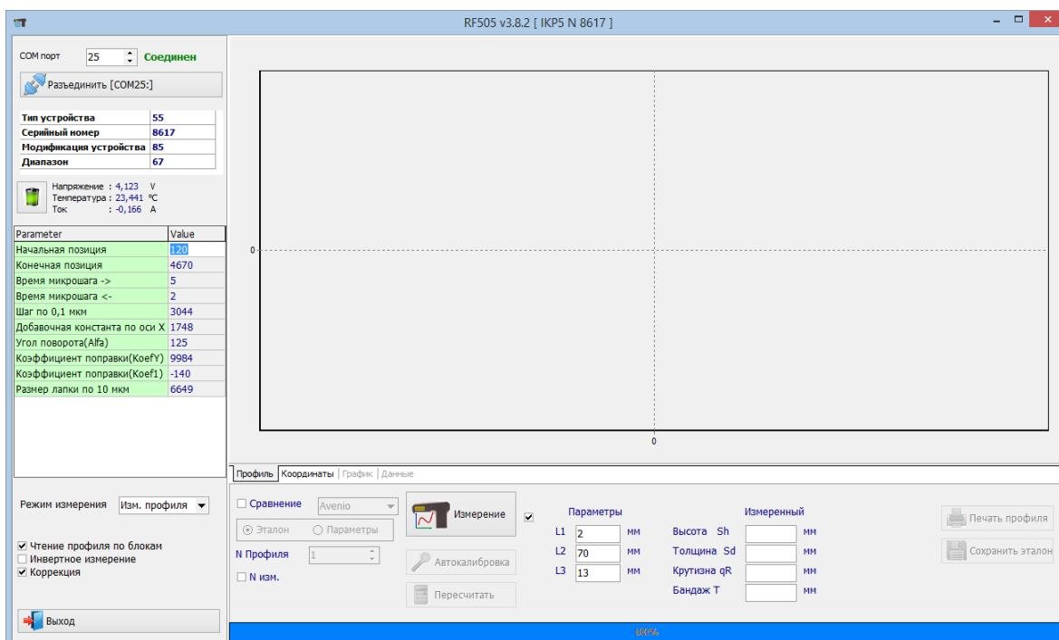
Для измерения на вкладке **Профиль** нажать кнопку **Измерение**. После измерения на дисплее будет отображен измеренный профиль и рассчитанные геометрические параметры профиля: Высота(Sh), Толщина(Sd), Крутизна(qR). Параметры рассчитываются в опорных точках L1, L2, L3.
