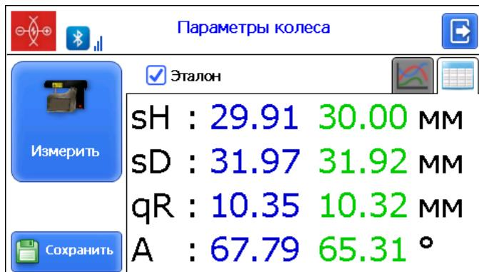
При выходе параметра за установленный допуск его значение выделяется красным цветом:
