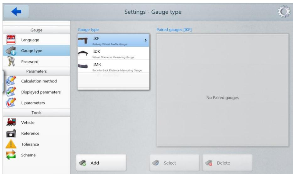
Если требуемое устройство включено в список, выберите его и нажмите кнопку **Select**. В дальнейшем, параметры выбранного устройства будут использоваться для соединения с ним. Если устройства нет в списке, вы можете добавить его – нажмите кнопку **Add** и перейдите к процедуре поиска Bluetooth-устройств.
