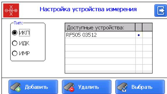
Если нужное устройство содержится в списке, достаточно выбрать его и нажать кнопку **Выбрать**. После этого КПК будет пытаться соединиться с выбранным устройством по умолчанию.
