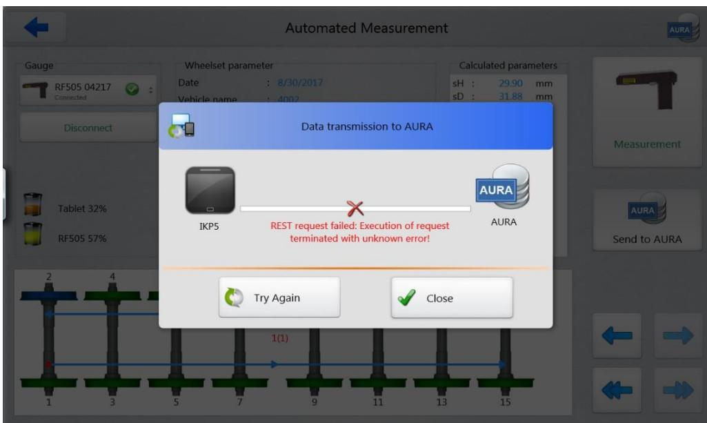
В данном случае нужно проверить Интернет подключение и попробовать передать данные еще раз – нажать кнопку **Try Again**.
