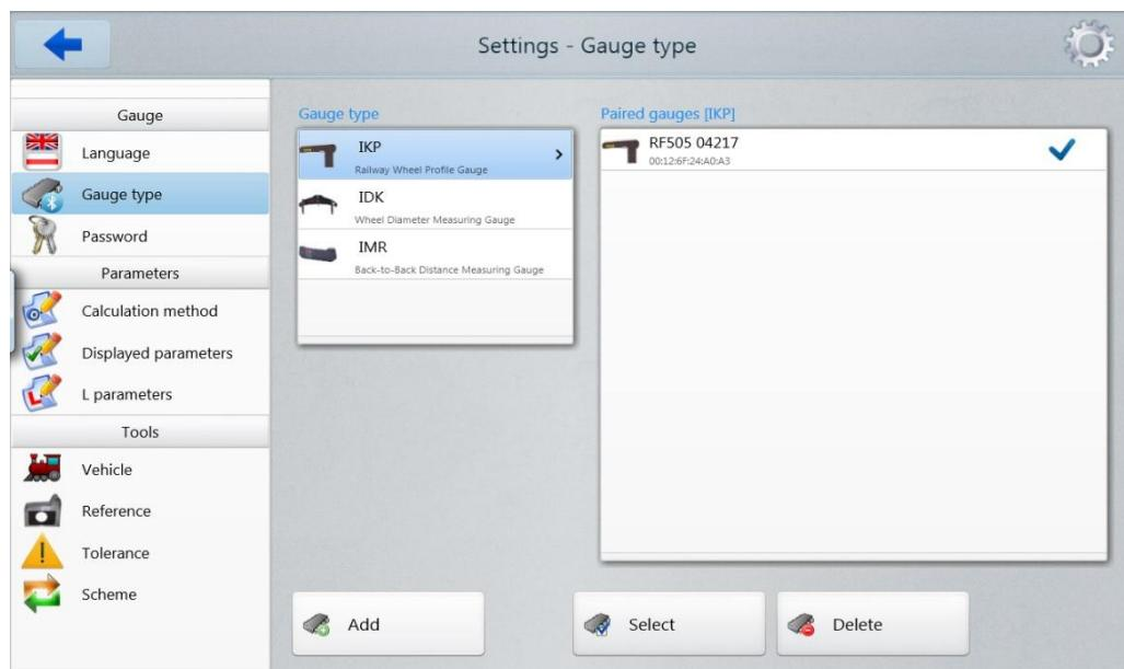
Вы можете удалить устройство, если оно не используется, нажав кнопку **Delete**. Аналогичным образом можно добавить другие устройства измерения (IDK и IMR).
