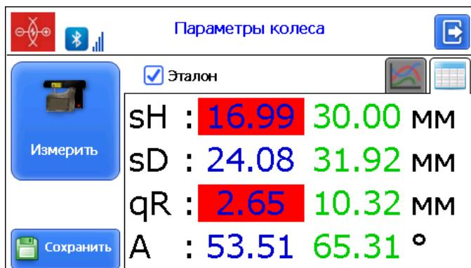
Программа позволяет вывести на экран только параметры измеренного профиля. Для этого нужно убрать отметку поля **Эталон**.
