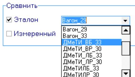
Для сравнения двух произвольных измеренных профилей друг с другом, (например, профилей левого и правого колес) следует выбрать сравнение с **Измеренным профилем**. Во вкладке **Таблица профилей** появится дополнительная таблица для выбора профиля для сравнения.
