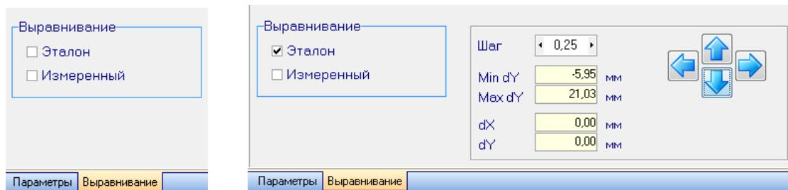
После выбора профиля, на экране будет выведено максимальное и минимальное отклонения выбранного профиля от эталона [Min dY..Max dY]
