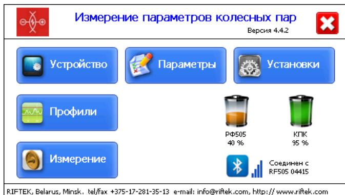
Кнопка **Измерение**, индикаторы Bluetooth соединения и серийный номер сканирующего модуля и заряда батареи сканирующего модуля становятся активными.
