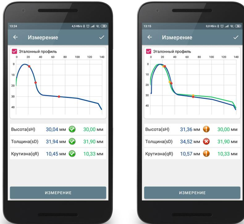
Программа позволяет вывести на экран только параметры измеренного профиля. Для этого нужно убрать отметку поля **Эталонный профиль**.
